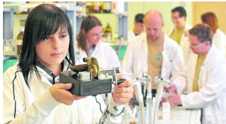
Im Chemielabor bereitet die künftige Geologietechnikerin Lisa Börner ein Casagrande-Gerät vor, das die Konsistenz eines Bodens ermittelt. FOTO: E. MILDNER
