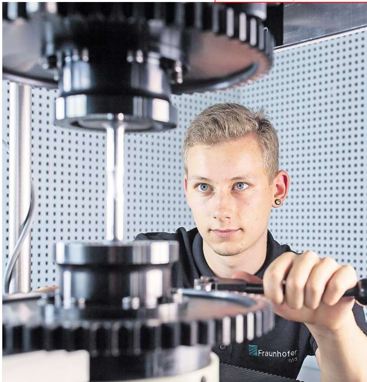
Fertig zum Belastungstest. Enrico Rehn spannt eine Aluminiumprobe in die Resonanzprüfmaschine. Am Fraunhofer-Institut in Dresden wird getestet, welchen Kräften Materialien standhalten können.
