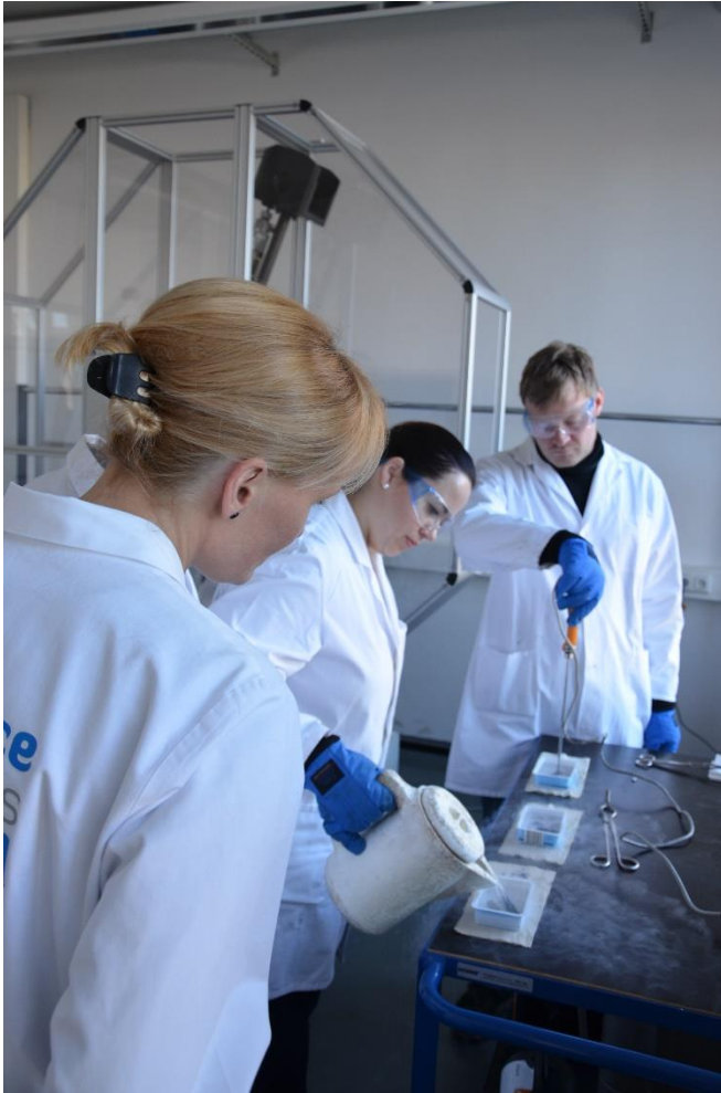
Teilnehmer kühlen die Proben für den Kerbschlagbiegeversuch mit flüssigem Stickstoff (-196 °C)
