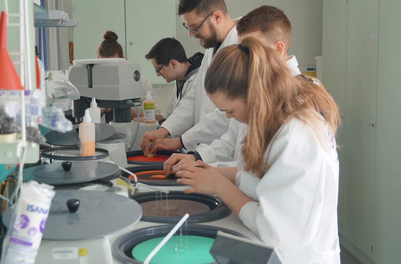
**AUF DEM WEG ZUR PERFEKTEN SCHLIFFQUALITÄT** | Werkstoffprüfer schleifen und polieren mit Hilfe unterschiedlicher Diamantscheiben. © BSZ JW Freiberg
