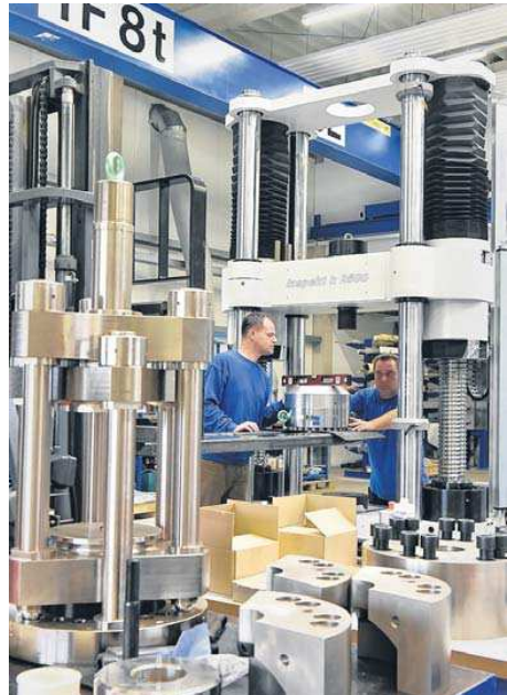
In der Firma Hegewald und Peschke in Nossen montieren Ivo Hake (l.) und Uwe Thürbach gerade eine Kraftmesszelle in eine Kalibriermaschine.
